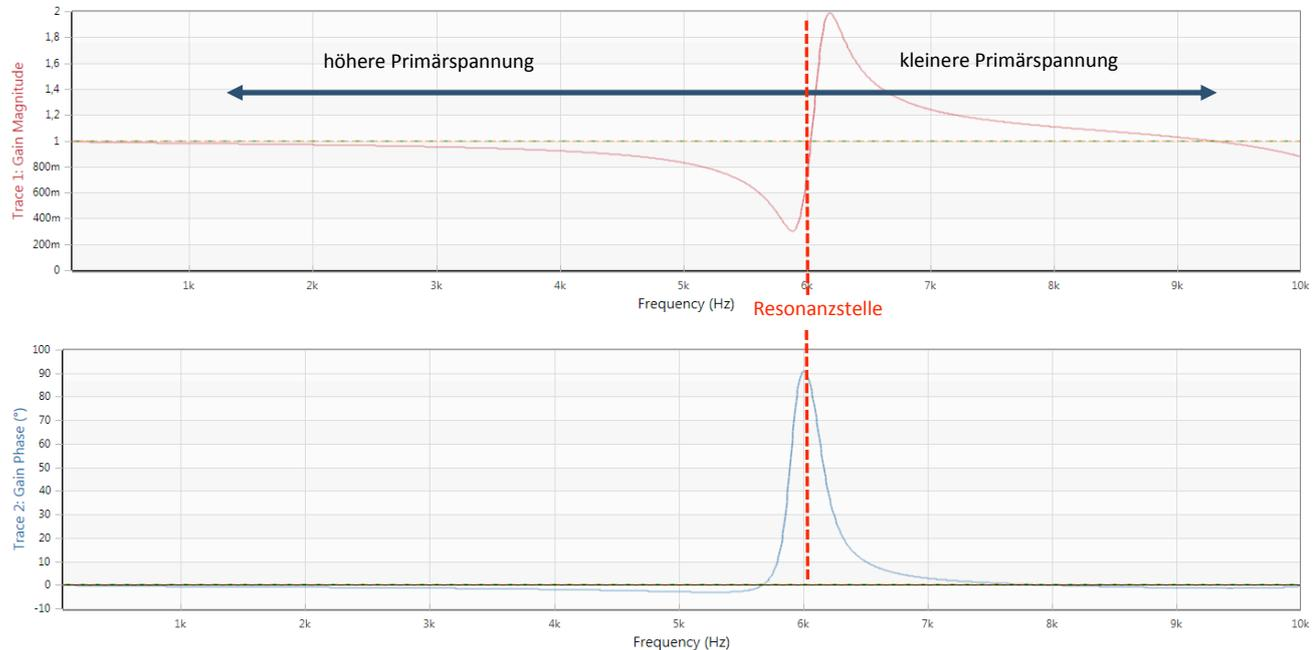
Abbildung 1: Frequenzübertragungsverhalten eines 10 kV Spannungswandlers mit hochohmiger Bürde
